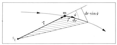
Abb.1 Zur geometrischen Deutung des zweiten Keplerschen Gesetzes (Flächensatz): In gleichen Zeiteinheiten werden vom Radiusvektor r gleiche Flächen (schraffiert) überstrichen.  $m=Satellit,\,r=geozentrischer Radiusvektor (vom Erdzentrum <math display="inline">S_E$  zum Satelliten).
