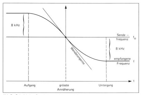
Abb. 7 Beispiel einer Dopplerkurve (nicht massstabsgerecht). f₀ = 400 MHz, Höhe des Satelliten über Boden h≅1000 km; dies ergibt eine maximale Dopplerverschiebung von ungefähr ±8 KHz.
