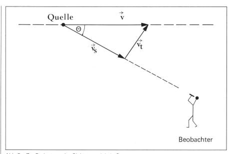
Abb. 5 Zur Bedeutung des Richtungswinkels  $\Theta$   $\vec{v}$  = Geschwindigkeitsvektor der Radioquelle  $\vec{v}_s$  = Komponente von  $\vec{v}$  in Richtung des Beobachters  $\vec{v}_t$  = Komponente von  $\vec{v}$  senkrecht zur Beobachtungsrichtung
