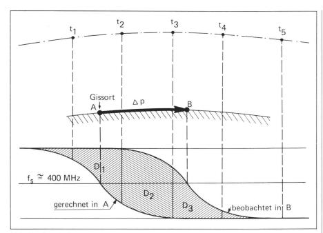
Abb.14 Dopplerkurven, wie sie die Beobachter A und B messen. Würde der Gissort um Δp verschoben, so wären die Kuven deckungsgleich.
