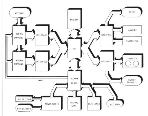
Abb. 16 Funktionsschema des MX 1502. CPU = Central Processing Unit RS 232 = Serielle Schnittstelle.
