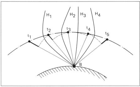
Abb. 13 Der Schnitt der verschiedenen Hyperboloide (H<sub>i</sub>) liefert die Position B.
