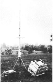
Abb. 15 Dopplerempfänger MX 1502 des Instituts für Geodäsie und Photogrammetrie der ETH Zürich in messbereiter Aufstellung (12-V-Batterie, Antenne, Empfänger/Mikroprozessor)
