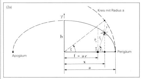
$=\frac{\sqrt{a^2-b^2}}{a}=$ numerische Exzentrizität. Durch e wird die *Form* der Bahnelipse festgelegt.
