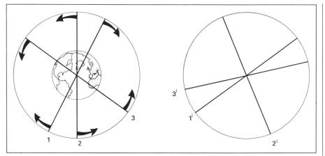
Abb. 9 Verteilung der Bahnebenen von einem Punkt über dem Nordpol aus gesehen. Links: zur Zeit to, rechts: zu einem späteren Zeitpunkt t.
