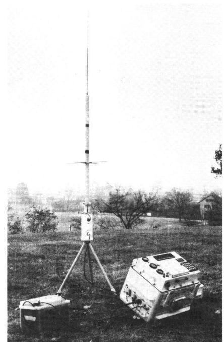
Abb.15 Dopplerempfänger Magnavox MX 1502 des Instituts für Geodäsie und Photogrammetrie der ETH Zürich in messbereiter Aufstellung (12-V-Batterie, Antenne, Empfänger/Mikroprozessor).
