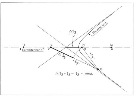
Abb. 12 Alle Punkte B auf dem Hyperboloid haben eine konstante Abstandsdifferenz  $\Delta s_2$  gegenüber den Brennpunkten 2 und 3.
