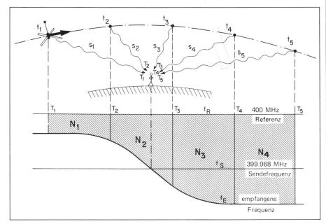
Abb. 10 Zur Veranschaulichung des Doppler-Messprinzips.  $N_i$  = Dopplercounts  $\cong$  schraffierte Flächen.
