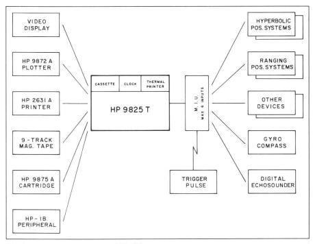
Abb. 3 Datenerfassungssystem GEOLOG
