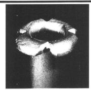
Pour satisfaire à la demande, fabrication automatique avec épanouissement du tube par déformation à froid.
