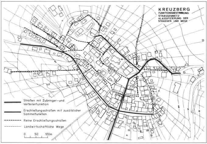
Abb. 6 Funktionsbestimmung und Klassifizierung der Strassen und Wege
