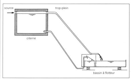
Fig. 6 Schéma du système (réserve sécheresse)
