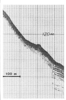
Abb. 7 Echogramm des Überganges vom Delta zur zentralen See-Ebene mit entsprechend zunehmender Eindringtiefe des Schalls im feinkörnigen Sediment.
