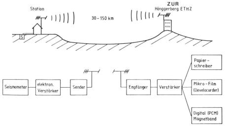
Abb.11 Blockschema der Fernübertragung seismischer Signale vom Seismometer S bis zur Registrierzentrale in der ETH-Hönggerberg.
