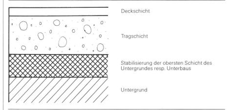
Abb. 2 Stabilisierung der obersten Schicht des Untergrundes bzw. Unterbaus
