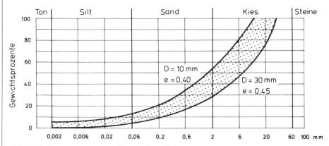
Abb. 7 Kalk-wassergebundene Verschleissschicht
