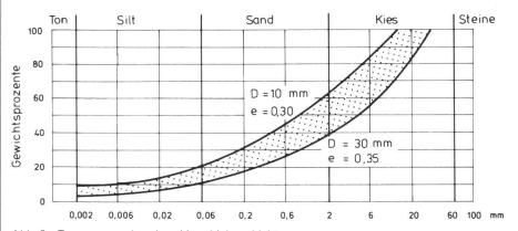
Abb. 6 Ton-wassergebundene Verschleissschicht
