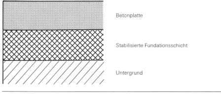
Abb. 3 Stabilisierte Schicht als Fundation für eine Betonplatte
