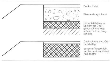
Abb. 4 Lage der zementstabilisierten Schicht bei Wald- und Güterstrassen
