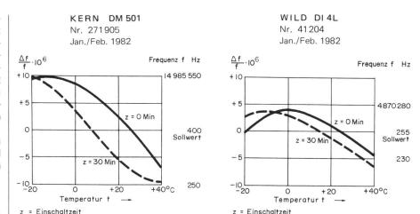
Abb. 5 Abhängigkeit der Frequenz von der Aussentemperatur beim Kern DM 501 und beim Wild DI 4L
