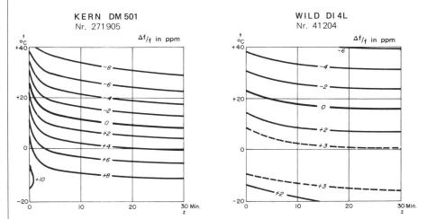
Abb.6 Relative Frequenzfehler (= relative Distanzfehler) in ppm zweier moderner EDM-Geräte in Abhängigkeit von der Umgebungstemperatur t und der seit dem Einschalten verstrichenen Zeit z
