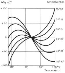
Abb.1 Frequenz-Temperatur-Winkel Kennlinien von metallbeschichteten AT-Typ-Resonatoren aus natürlichem Quarz. Aus Frerking: Crystal Oscillator Design [1]
