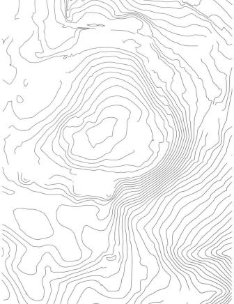
Abb. 8 Regelmässiges Basisgitter  $20\,x\,20\,m$  , zusätzlich lokal verdichtet bis  $5\,x\,5\,m$  (mit Bruchkanten)
