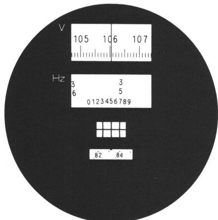
Im schwenkbaren Ablesemikroskop des neuen Wild T0 sieht der Beobachter beide Kreisbilder auf einen Blick. Zur Vermeidung von Verwechslungen ist der Vertikalkreis blau, der Horizontalkreis gelb beleuchtet. Sind die Gradteilungsstriche mit dem grossen Mikrometertrieb genau koinzidiert, so kann man den Horizontalkreis digital (357,83°) und den Vertikalkreis auf der Skala (106,04°) ablesen.
