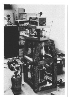
Abb.3 Apparatur für die absolute Schwerebestimmung
