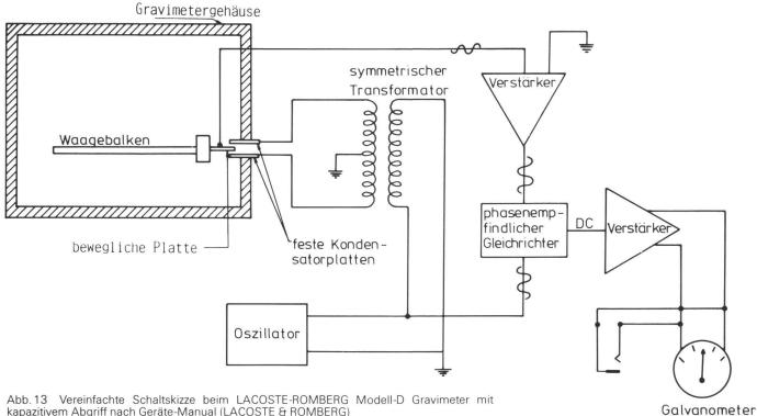
Abb. 13 Vereinfachte Schaltskizze beim LACOSTE-ROMBERG Modell-D Gravimeter mit kapazitivem Abgriff nach Geräte-Manual (LACOSTE & ROMBERG)
