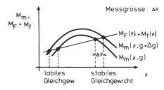
Abb. 9 Gravimeter-Charakteristiken
