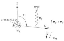
Abb.8 Prinzip der relativen Schweremessungen
