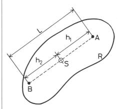
Abb. 2 Prinzip des Reversionspendels
