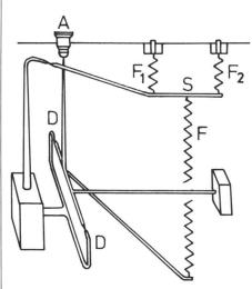
Abb.11 Prinzip des WORDEN-Gravimeters. DD = Drehachse, F = Hauptfeder,  $F_1 = Ablesefeder$ ,  $F_2 = Messbereichsfeder$ , A = Ablesung der Messlage-Anzeige
