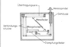
Abb. 12 Prinzip des LACOSTE-ROMBERG-Gravimeters: Die Messfeder greift schräg am Waagebalken an. Die Dämpfungsfeder ist über  $m_1$  mit dem Gehäuse fest verbunden.
