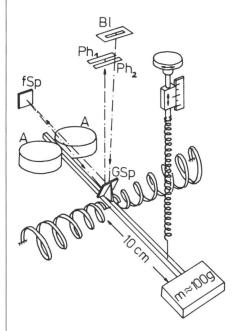
Abb.10 Prinzip des ASKANIA-Gravimeters (Torsionsfederwaage). A = Auftriebskörper, BI = Spaltblende, GSp = Gehängespiegel, fSp = fester Spiegel, Ph<sub>1</sub>, Ph<sub>2</sub> = Photozellen
