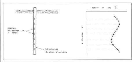
Fig. 5 Mesure d'humidité à différentes profondeurs et tracé du profil hydrique correspondant
