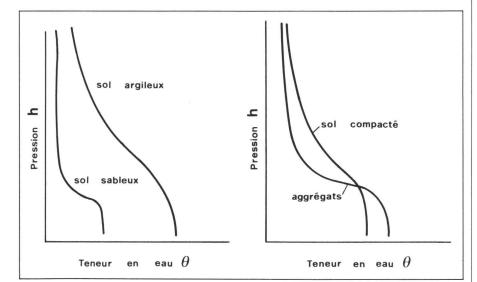
Fig. 1 Influence de la texture et de la structure sur les courbes caractéristiques de l'humidité du sol
