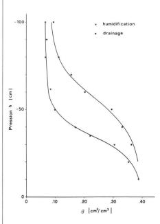
Fig. 11 Courbe caractéristique d'humidité
