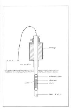
Fig. 4 Schéma d'une sonde à neutrons
