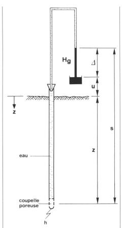
Fig. 6 Tensiomètre
