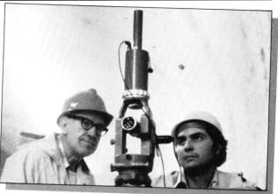
WILD T 16 als Tunnelbau-Theodolit Um nach jeder Kurve die neue Tunnelrichtung eines Entwässerungs-Tunnels in Chicago nachzuprüfen, wird der WILD T 16 mit dem nordsuchenden Kreisel GAK 1 versehen.
