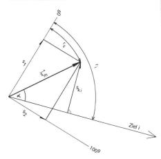
Abb.3 Stehachsenschiefe bei Satzmessung
