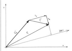
Abb. 2 Mittlere Stehachsenschiefe  $\vec{s}_m$ , Taumelfehler  $\vec{t}_i^*$
