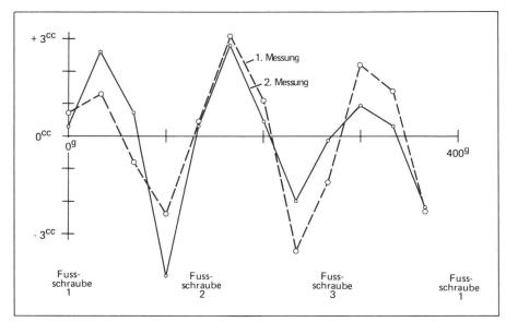
Abb. 5 Taumelfehler Stehachse DKM2-AM
