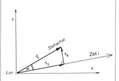
Abb. 1 Stehachsenschiefe  $\vec{s}$ , Komponenten  $s_7$ ,  $s_k$
