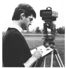
(Citation) bildet nicht nur mit Wild-Theodoliten (im Bild auf dem Skalen-Theodolit Wild T16), sondern auch mit Theodoliten anderer Hersteller eine sehr leistungsfähige Tachymetrie-Ausrüstung. Bemerkenswert: das übersichtliche Bedienungsfeld mit Berührungstasten und grossziffriger Flüssigkristall-Aggeige.
