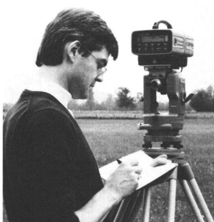
«Citation» bildet nicht nur mit Wild-Theodoliten (im Bild auf dem Skalen-Theodolit Wild T16), sondern auch mit Theodoliten anderer Hersteller eine sehr leistungsfähige Tachymetrie-Ausrüstung. Bemerkenswert: das übersichtliche Bedienungsfeld mit Berührungs-tasten und grossziffriger Flüssigkristall-Anzeige
