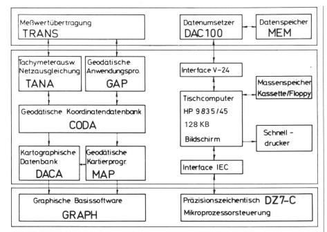
Abb. 1 Geodätisches Auswertesystem Zeiss GEOS-1, Soft- und Hardware-Komponenten
