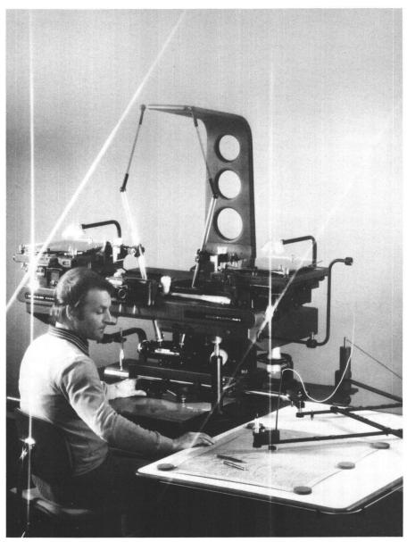
Abb. 2 Der Wild AG1 – das neueste Modell der erfolgreichen Aviograph-Linie. Besonders hervorstechendes Merkmal neben der erhöhten Genauigkeit ist die ergonomisch optimale Anordnung sämtlicher Bedienungselemente in bequemer Reichweite des Operateurs. Die Pantograph-Zeichnung entsteht lageorientiert zum Operateur.
