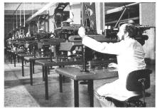
Abb. 7 Letzte Kontrolle an einer AG1-Produktionsserie im Werk Heerbrugg: die geforderten Toleranzen werden durchwegs unterschriften.
