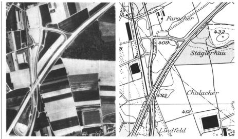
Abb. 7 Wiedergabe der Nachrichten (Gebäude) und (offenes Gelände). Links in einem Flugbild, rechts in einer Karte
