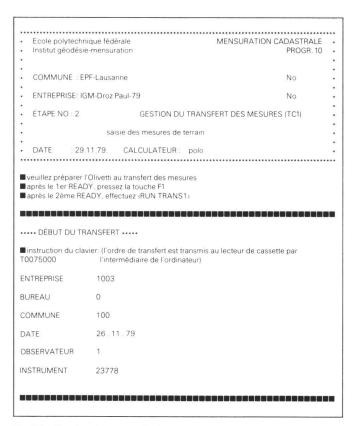
Fig. 7.1 En-tête du protocole des mesures et identification du levé (réduit)
