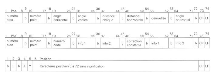
Fig. 5 Format des blocs de données à la sortie du lecteur de cassette
