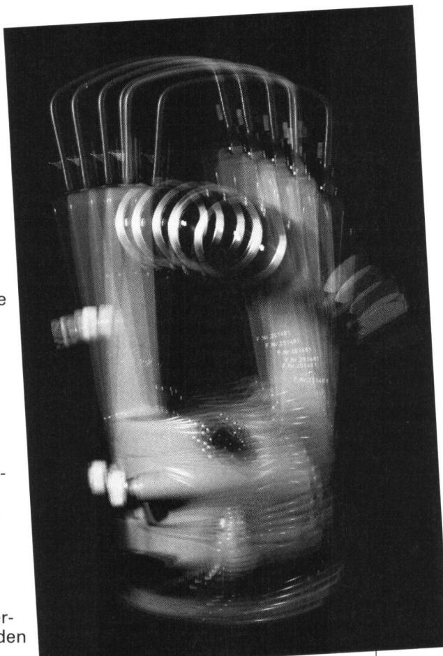
*Skalen-Theodolit WILD T 16 im Schütteltest. Wild-Theodolite müssen härtesten Belastungen widerstehen. Prüfmethoden nach DIN- und MIL-Spezifikationen garantieren zuverlässige und genaue Instrumente.*
