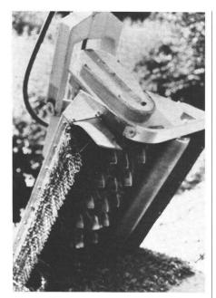
Abb.3 Schlagwerk einer hydraulisch gesteuerten Mähmaschine für den Vorflutunterhalt im Gailtal
