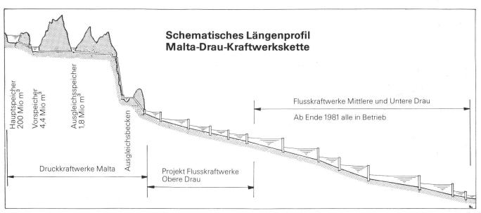
Abb. 5 Schematisches Längenprofil der Malta-Drau-Kraftwerkskette. Die Längen und Höhen sind nicht massstabsgetreu aufgetragen
