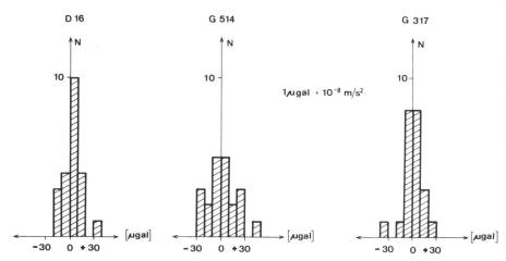
Fig. 2 Histogrammes des dérives de travail des trois gravimètres utilisés durant la campagne de mesure de 1980.
