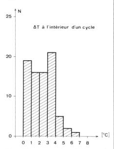
Fig. 3 Histogramme des différences de température mesurées à l'intérieur d'un même cycle.
