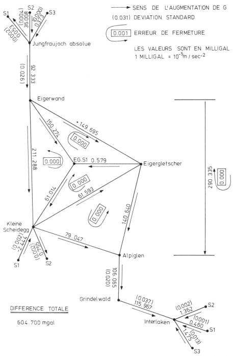
Fig. 4 Schéma des distributions spatiales des différences de pesanteur sur la ligne de calibration Interlaken-Jungfraujoch.
