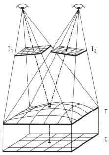
Fig. 1 Principe de la restitution de prises de vues en photogrammétrie. On présente à l'opérateur deux vues homologues I<sub>1</sub>, I<sub>2</sub>, qui fusionnent comme dans le cas de la vision naturelle; l'opérateur a ainsi l'impression de voir le terrain en relief (T). Le plan (C) correspond à la carte, projection orthogonale du terrain.
