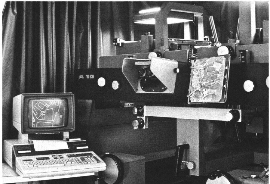
Fig. 4 Restituteur photogrammétrique de haute précision (autographe Wild A10) en liaison avec une calculatrice de table (Hewlett-Packard 9845).
