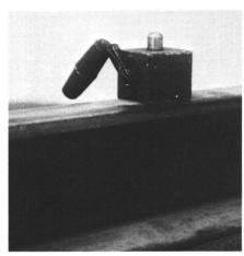
Abb.3 Magnetischer Lattenuntersatz für Schienennivellement
