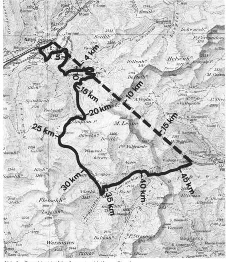
Abb. 1 Grundriss der Nivellementsschleife am Simplon
