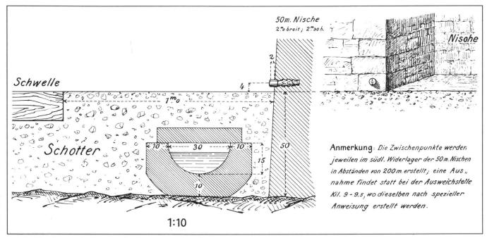
Abb. 2 Detailskizze der Fixpunkte im Simplontunnel (SGK 1910)
