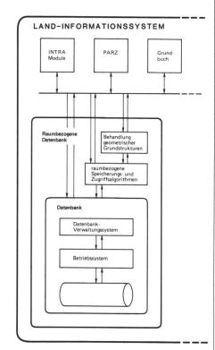
Abb. 2 Schichtweiser Aufbau eines Programmsystemes
