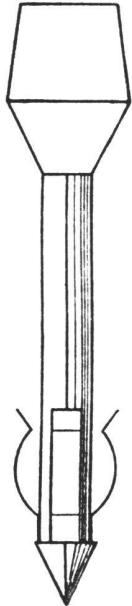
Verwenden Sie deshalb Grenzmarken aus Polyesterbeton mit dem Zeichen der Windrose. Stahlrohrsäfte mit Spreizanker.
