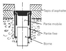
Fig. 1 La cape est en deux parties, une partie fixe et une partie mobile.
