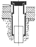
Fig. 2 La partie mobile est relevée avec un arrache poulie.
