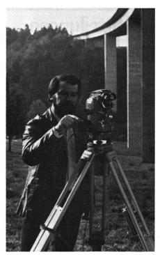
Auf einen Theodolit aufgesetzt, stellt der neue Distomat Wild DI4 eine äusserst kompakte Messausrüstung dar. Dem Vermessungsfachmann erleichtert sie die Feldarbeit beträchtlich. Winkel, Distanzen, Höhenunterschied und Koordinatendifferenzen sind in wenigen Sekunden nach einer einzigen Zielung exakt ablesbar.
