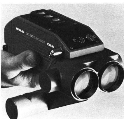
Dank Mikroprozessor klein, handlich und leistungsstark: der neue reduzierende Infrarot-Tachymeter Distomat Wild DI 4.
