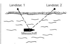
Abb. 4 Prinzip der zweidimensionalen Fahrweise.
