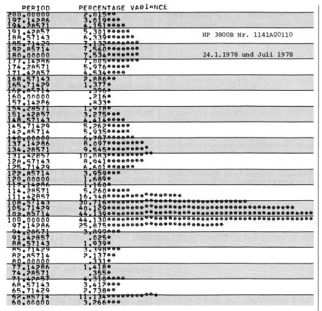
Abb. 3 Computeroutput einer Frequenzanalyse. In Abhängigkeit der Wellenlänge der ausgeglichenen Sinuskurve ist die prozentuale Abnahme der Varianz und eine entsprechende graphische Darstellung ausgedruckt. Instrument: Hewlett-Packard HP 3800B Nr. 1141A00110. Details in Tabelle 4.
