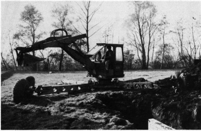
Abb. 3 Teleskop-Schreitbagger (System Kaiser, Schaanwald FL) im Einsatz. Vordere Arme mit beweglichen Doppelrädern zur Lastverminderung, lichte Breite bis 5.5 m. Hintere Arme mit Auflagerplatten.
