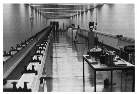
Abb. 3 Messkeller im Ausbau: Links 50 m-Messbahn, hinten Klimakabine, rechts Pfeilerbasis und Latten-Komparator.
