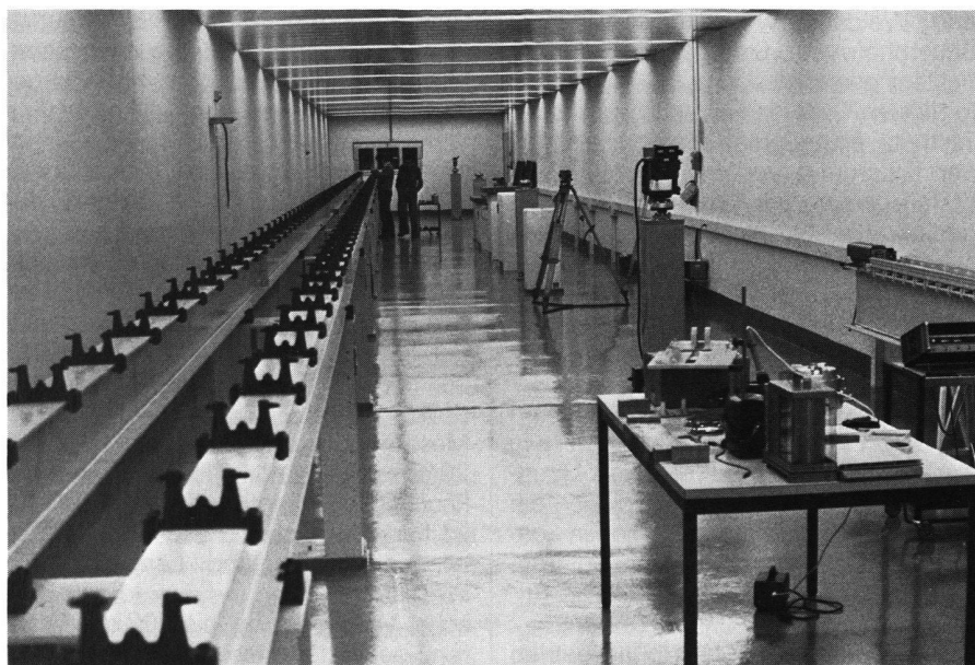
Abb. 3 Messkeller im Ausbau: Links 50 m-Messbahn, hinten Klimakabine, rechts Pfeilerbasis und Latten-Komparator.
