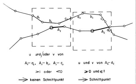
Abb. 7 Algorithmus für das Schneiden zweier Linien
