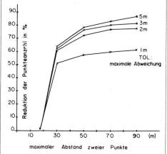
Abb. 3 Punktreduktion in Funktion der Abweichung und des Abstandes
