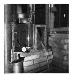
Abb. 5 Eichung eines Janertschen Drainwassermessers im Kulturtechnischen Labor
