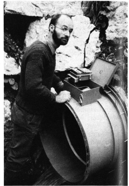
Abb.11 Eine Abflussmess-Station im hydrologischen Testgebiet Grosser Runs, SZ
