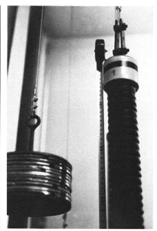
Abb.8 Zug- und Torsionsversuche an Drainrohren aus PVC
