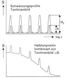
Abb. 19b Die Wirkung der Tonlinienstruktur, einem Halbtonpositiv überlagert
