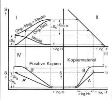
Abb. 5 Tonreproduktion eines Halbtonnegativs von reduziertem Schwärzungsumfang mit Hilfe einer Gradationsmaske. Von den Kopierschwärzungskurven A und B, mit den Entwicklungszeiten  $t_1$  und  $t_2$ , ist eine verzerrungsfreie Wiedergabe nur über das Kopiermaterial A mit  $\Delta \log H_K \equiv \Delta S_{N+M}$  gegeben.
