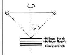
Abb. 15 Beleuchtungsgeometrie und Kopieranordnung beim Tonlinienverfahren
