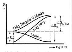
Abb. 4 Veränderung des Originalgrautonverlaufes mit Hilfe einer gegenläufigen Maske:
