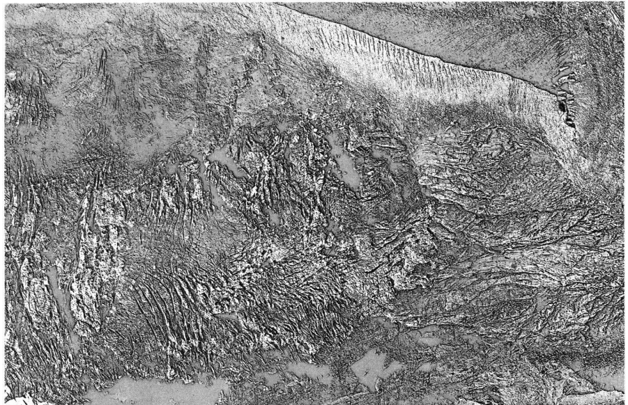
Abb. 24 Kornstruktur- und autotypisch gerastertes Orthophoto kombiniert. Die Rastertonflächenbedeckung der dunkelsten Stelle des gerasterten Bildbeitrages beträgt ca. 40% in 60 L/cm Rasterweite.
