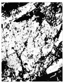
Abb.13 Durch Umkopieren vom Halbtonbild photographisch erzeugte Maskenschablone
