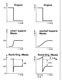
Abb. 8 Schematische Darstellung der Maskenwirkung an einem kleinen Detail (Kante); a) mit scharfer Maske, b) mit unscharfer Maske (Amplitudenmaske).
