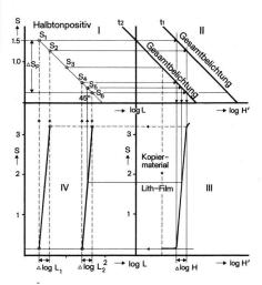
Abb.11 Wiedergabe ausgewählter Schwärzungsniveaus einer Halbtonvorlage mit einem Lithmaterial in zwei verschiedenen Gesamtbelichtungen t<sub>1</sub> und t<sub>2</sub>
