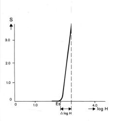
Abb.10 Schwärzungskurve einer Lithschicht, aufgetragen in Funktion der Belichtung logH.
