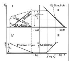
Abb. 7 Tonreproduktion eines Halbtonnegativs, mit Hilfe einer in die Gradationsmaske integrierten Schattenmaske. Bei der optischen Übertragung muss die nichtlineare Verzerrung, verursacht durch Streulicht (II. Quadrant, gestrichelte Linie) in Betracht gezogen werden.
