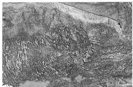
Abb. 24 Kornstruktur- und autotypisch gerastertes Orthophoto kombiniert. Die Rasterton-Flächenbedeckung der dunkelsten Stelle des gerasterten Bildbeitrages beträgt ca. 40% in 60 L/cm Rasterweite.
