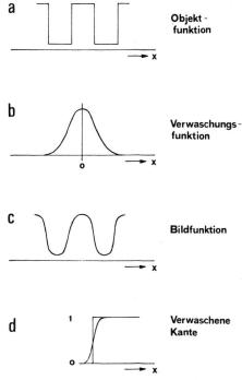
Abb. 2a-d Übertragungsfunktion einer scharfen Kante
