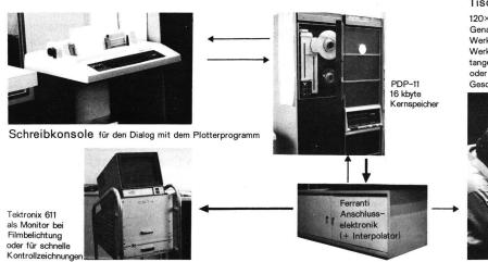
Abb. 1 Konfiguration der Anlage im Institut für Kartographie der ETH Zürich
