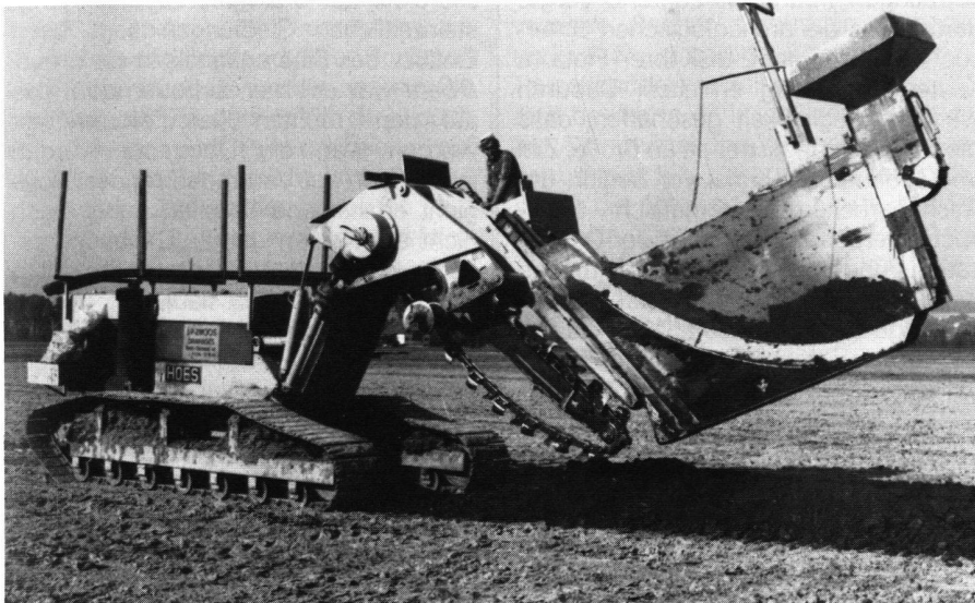
Abb. 6 Drainfräse Hoes Gigant mit angehobenem Arbeitsbaum
