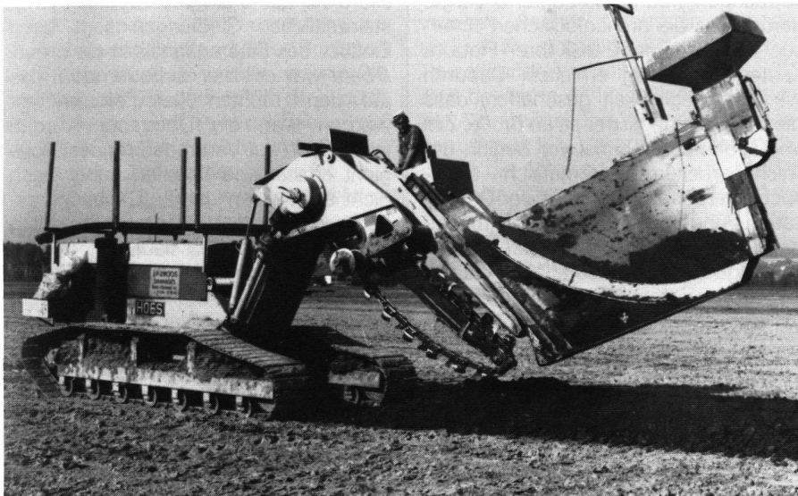
Abb. 6 Drainfräse Hoes Gigant mit angehobenem Arbeitsbaum
