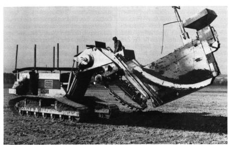
Abb. 6 Drainfräse Hoes Gigant mit angehobenem Arbeitsbaum
