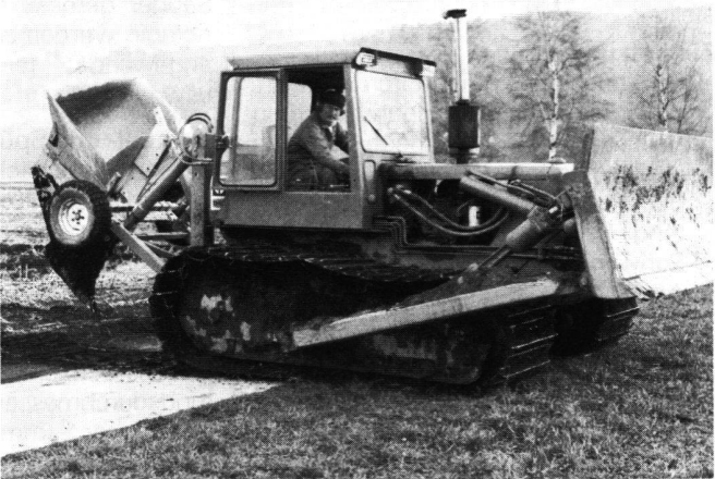
Abb. 4 Bulldozer D4D mit angebautem Schlitzdrainagegerät
