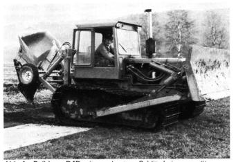
Abb. 4 Bulldozer D4D mit angebautem Schlitzdrainagegerät
