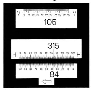
V: 105,565 gon H rechtsläufig: 315,635 gon H linksläufig: 84,365 gon Oder sind Sie ein Mikrometer-Fan? Und ziehen Sie eine Ablesung vor, die den vollständigen Messwert mit Ziffern anzeigt und das Abzählen und Schätzen von Teilungsintervallen überflüssig macht?
