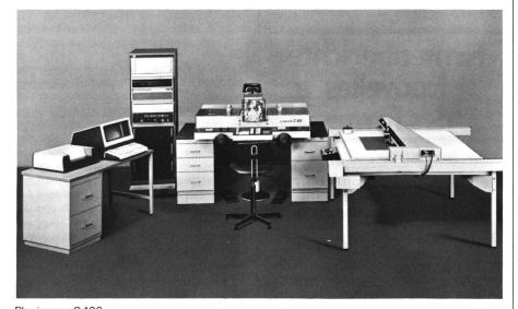
Planicomp C 100 Das neue analytische Stereoauswertesystem für alle photogrammetrischen Auswerteaufgaben.
