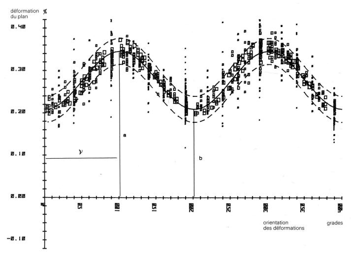
820 distances calculées (Réseau de coordonnées) a = 0.346%, b = 0.209%, v = 101,446 grades, erreur moyenne à craindre sur a et b: 0.0133%
