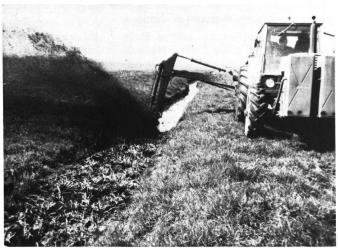
Abb. 3 Sohlenreiniger mit Rotor bei der Grabenreinigung
