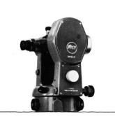
Kern E1. Elektronischer Theodolit mit Registriergerät
