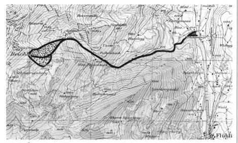
Abb. 1 Übersicht des Einzugsgebietes des Hellschwandbaches (ca. 1:30 000, reproduziert mit Bewilligung der eidg. Landestopografie vom 11.9.80). Im Norden der abgefahrene Teil des Bergrutsches, im Süden der zu Stillstand gekommene.
