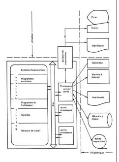
Fig. 4.1 Représentation schématique du matériel
