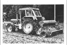
Abb. 6 Ansaat mit einer Fräs-Sä-Kombination in einem Arbeitsgang
