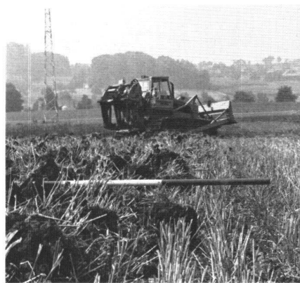
Abb. 7 Primärauflockerung ergibt eine Zunahme des Porenvolumens von 20–30%
