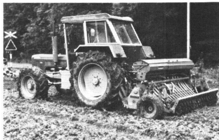
Abb. 6 Ansaat mit einer Fräs-Sä-Kombination in einem Arbeitsgang
