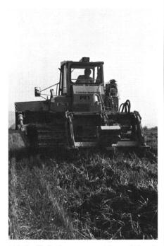
Abb. 1 Tieflockerungsmaschine, mit der die Versuchsfelder gelockert werden
