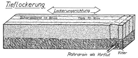
Darst.3 Tieflockerung in einem staunassen Gebiet, kombiniert mit einer weitmaschigen Rohrdrainage
