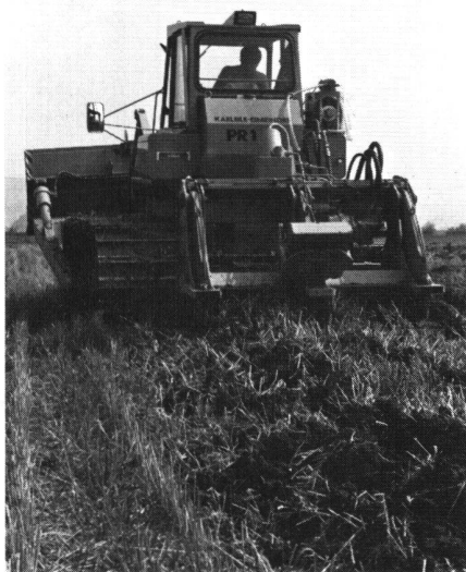
Abb. 1 Tieflockerungsmaschine, mit der die Versuchsfelder gelockert werden
