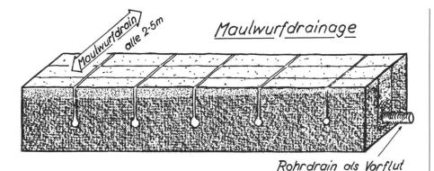
Darst. 4 Maulwurfdrainage zur Unterstützung einer Rohrdrainage in einem grundnassen Boden oder zur Vorentwässerung eines staunassen Bodens
