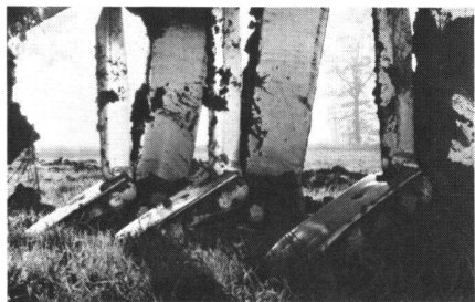
Abb. 5 Tieflockerungsmaschine mit dreischarigem Lockerungsaggregat
