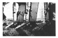
Abb. 5 Tieflockerungsmaschine mit dreischarigem Lockerungsaggregat
