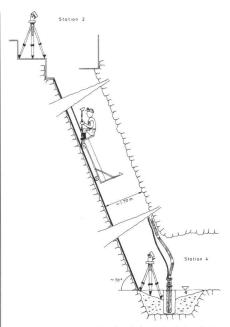
Fig. 4 Relevé des détails de la galerie inclinée
