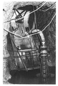
Fig. 1 Le wagonnet du funiculaire et la pompe pour l'évacuation de l'eau au bas de la galerie inclinée.
