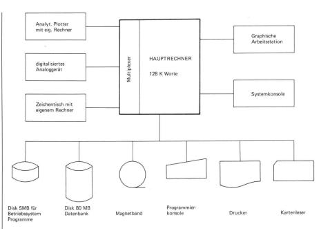
Abb. 9 Die wesentlichsten Komponenten eines computergestützten photogrammetrischen Auswertesystems
